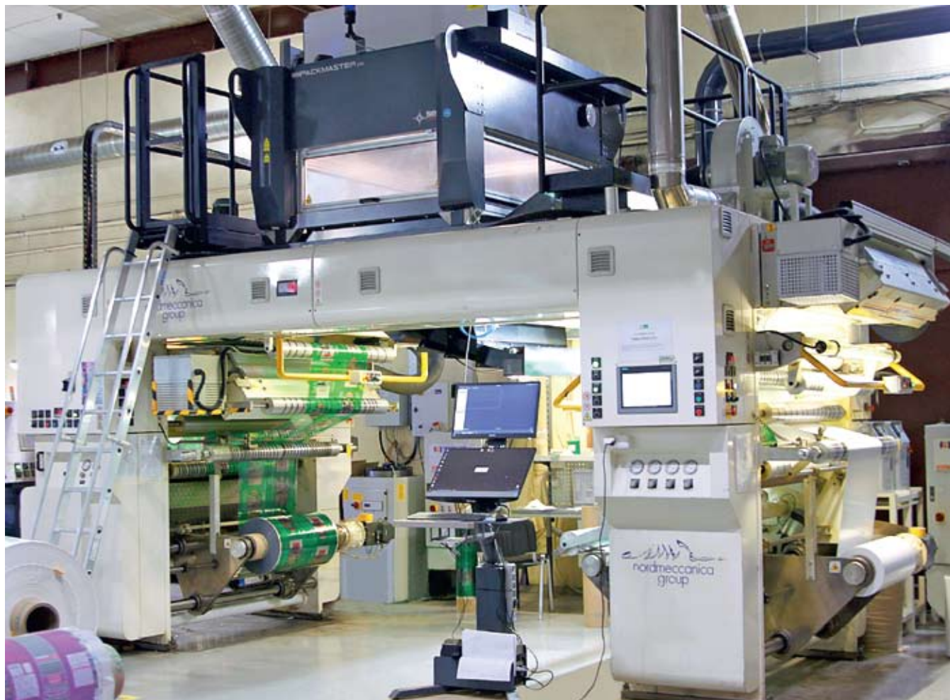
Лазерной устройство Packmaster CW на ламинаторе в производственном цехе компании «Конфлекс»
